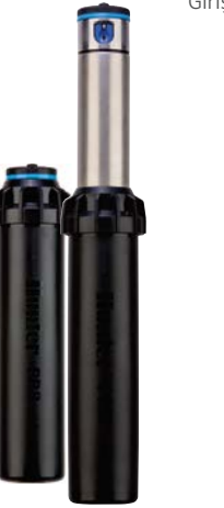
I-20-06-PRB Toplam yükseklik: 27 cm Pop-up yüksekliği: 15 cm Çıkış çapı: 4,5 cm Giriş çapı: ¾"
